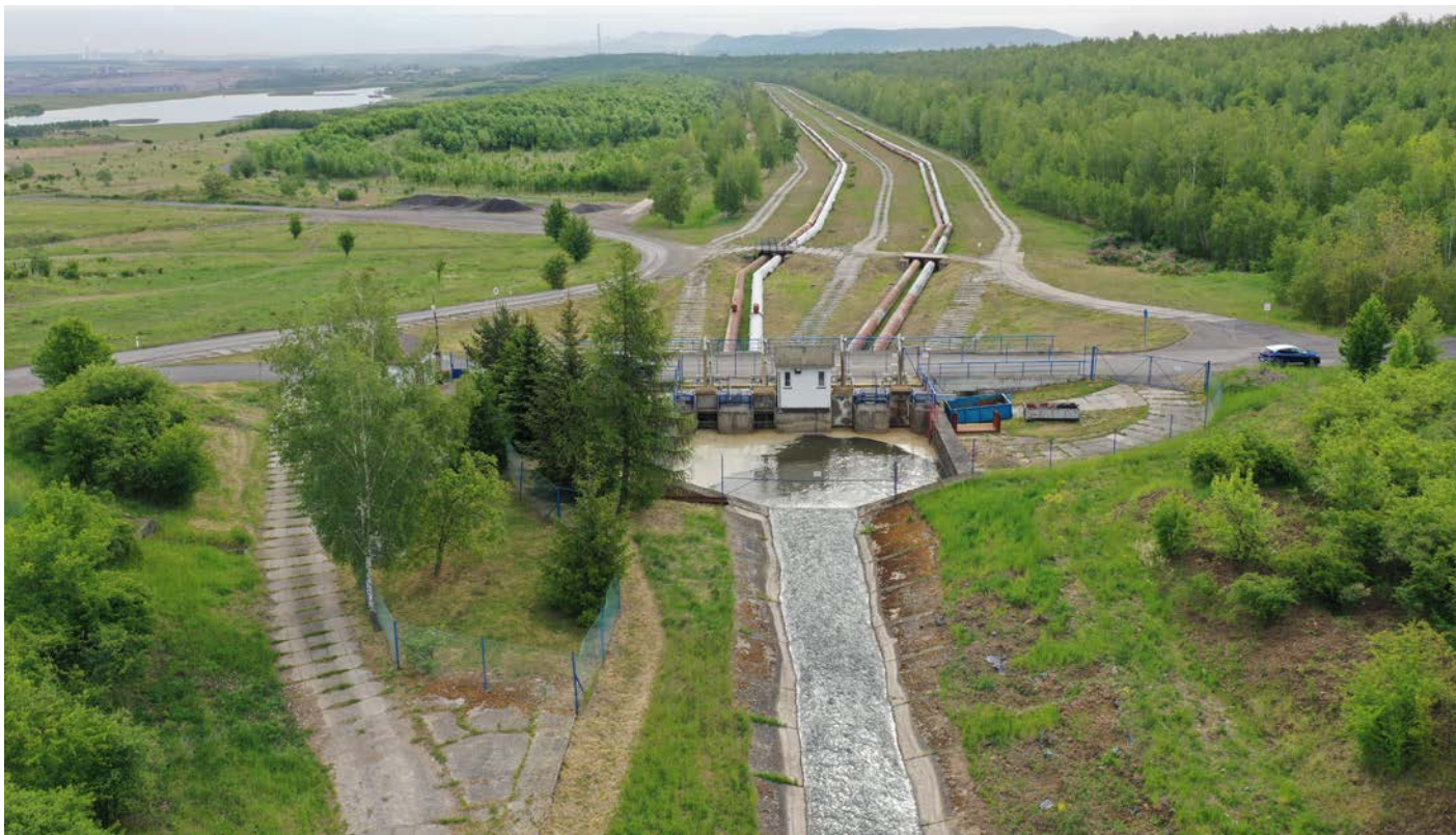
Abb. 18. Die Biela wird im Korridor Ervěnický koridor in einer Länge von 3 km in vier Rohrleitungen eingeleitet. Eine Barriere für sämtliches, an den Fluss gebundenes Leben. Das schließt auch den Fischotter und die Fische ein (Aufnahme Jindřich Poledník); Fig. 18. Bílina river is reduced to four pipelines in the length of 3 km on the Ervěnice corridor. An absolute barrier to all life tied to the river, including otters or fish (photo by Jindřich Poledník)
