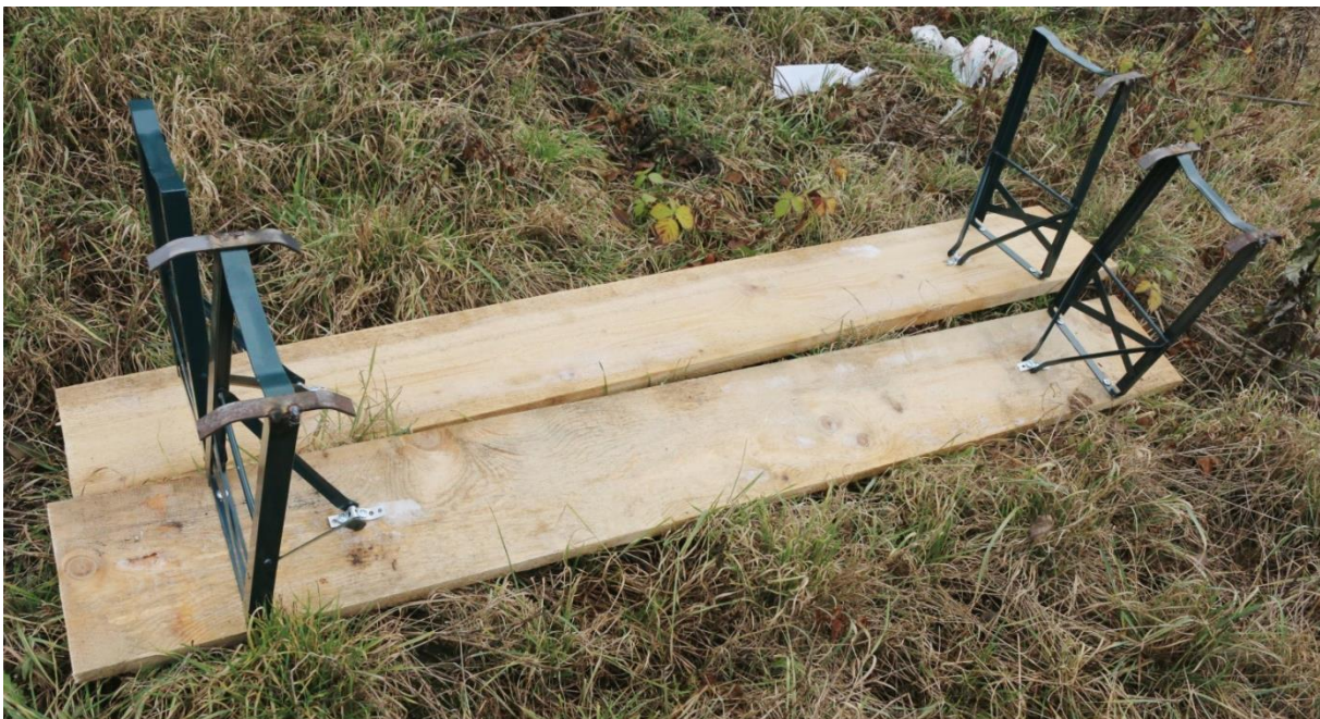
Obr. 4 Samonosná lávka vytvořená z dvoumetrových dílů. Každý díl má své nohy. Nohy byly vytvořené z komerčně prodávaných noh pro lavice s přivařenými „lyžinami“. Lyžiny slouží k manipulaci s lávkou při instalaci v propustku.
